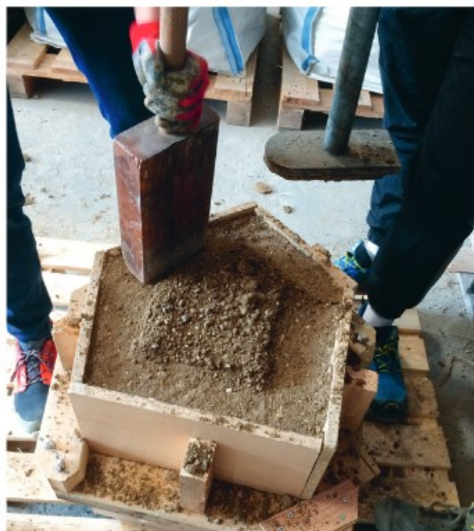
Des étudiants tassent la terre dans un coffrage afin de réaliser un échantillon en pisé
